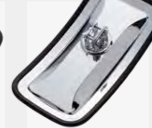
JV 玉付 サイドミラー [品番] KM70-522 鉄・メッキ仕上げ 取付サイズ M10 取付 ピボット式P-8 曲率 380R
