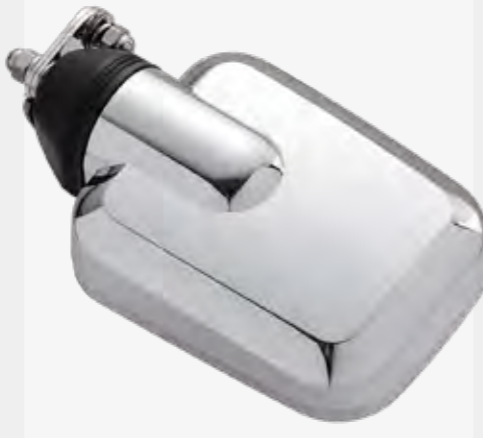
サイドコンポーネント ミラー [品番] KM-973 ABS/クロームメッキ 取付サイズ 28mmΦ 曲率 平面
